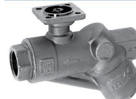
Den tryk-ufahængige kugle-reguleringsventil holder et konstant flow indenfor trykområdet 30... 350 kPa. Ved hjælp af ventilmotoren kan flow'et indstilles til den ønskede værdi. For yderligere oplysninger: Se datablad på [www.belimo.dk](http://www.belimo.dk)
